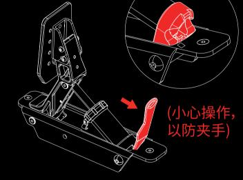
将撬棍放到弹簧桶底侧,向下用力,小心的将弹簧桶撬出
