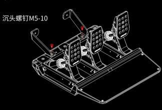
② 将靠墙板装在左右支架上,使用两颗螺钉锁紧, 装配完成
