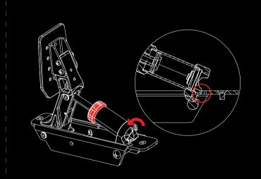
将撬棍翻转,放入弹簧桶底侧,向上用力将弹簧桶推入槽内
