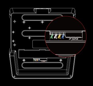
将踏板翻转至底部进行接线,按照线材颜色插入对应插口
