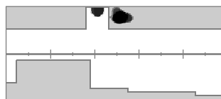
Sledování cíle kanadské 10¢ mince z roku 1998 (přijato) a přímo sousedící hřebík (odmítnuto).
