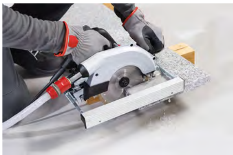
Högrepresterande motor: extra kraftfull för stenkäpning och fogfräsning.
