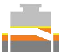
Fallo parcial de revestimiento
