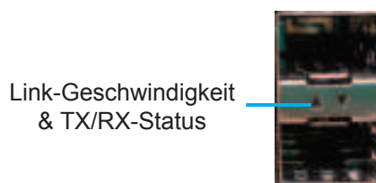
Abbildung 4. Ethernet SFP Port LEDs
