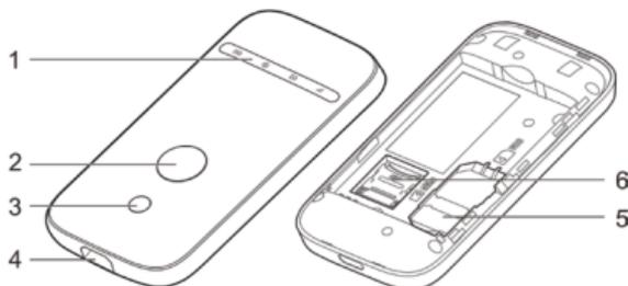
1. Indicatori LED di stato. Servono a fornire all'utente informazioni sullo stato del dispositivo.
