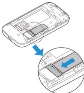
**IMPORTANTE:** Il dispositivo non supporta SIM di tipo Micro, Nano o di formati non standard. Fare molta attenzione nel caso in cui si dovessero usare adattatori SIM, in quanto l'adattatore potrebbe rovinare i contatti dell'alloggiamento della SIM.
