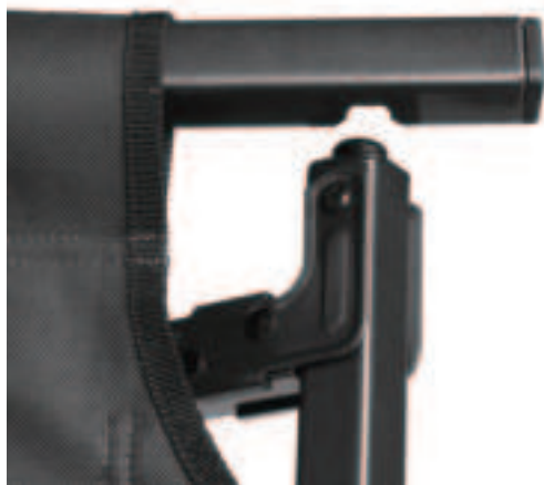
Étape 4 Faites glisser une barre du bout dans la poche au pied du lit de camp. Assurez-vous que l'encoche de la barre du bout soit positionnée comme illustré à la figure 4. Lorsqu'elle est bien positionnée, l'encoche s'adaptera sur le bouton du lit de camp et on pourra l'appuyer pour verrouiller en place.
