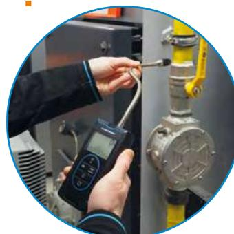
RILEVA LE PERDITE DI GAS COMBUSTIBILI A MONTE DI UN BRUCIATORE DI CALDAIA
