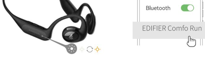
Accendere il dispositivo e selezionare "EDIFIER Comfo Run" nelle impostazioni del dispositivo per collegarsi.
