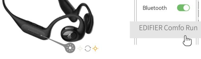
Ligue e selecione "EDIFIER Comfo Run" nas configurações de seu dispositivo para estabelecer conexão.
