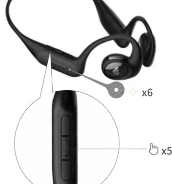
Schalten Sie das Gerät ein und drücken Sie dann 5 Mal auf die MFB, um es auf die Werkseinstellungen zurückzusetzen.
