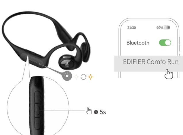
1. Halten Sie im ausgeschalteten Zustand einen der beiden MFB 5 Sekunden lang gedrückt.
