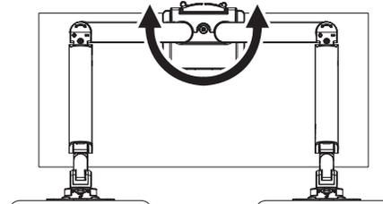
①アーム内側のリミッターネジを締めると、アームは180°の範囲だけで稼働するようになります。
