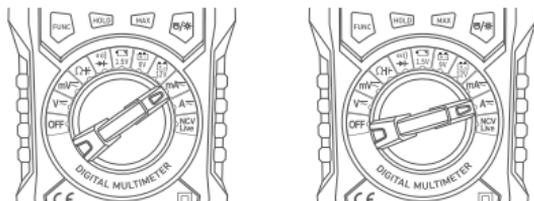
2. Drücken Sie die FUNC-Taste, um zwischen Wechsel- bzw. Gleichstrom umzuschalten.
