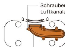
Schrauben für die Luftkanalabdeckung
