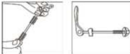
**2.3 Installare la ruota anteriore sulla forcella. Assicurarsi che la forcella sia fissata all'asse e che il disco sia posizionato al centro del freno.**
