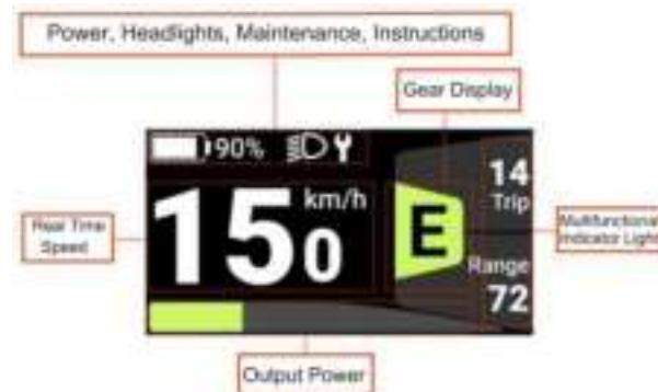
3.1 Indication multifonctionnelle : divisée en kilométrage simple TRIP et kilométrage total RANGE.
