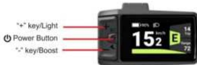
4.1 Allumer/éteindre : appuyez longuement sur le bouton d'alimentation ( $\geq 2$  s) pour allumer appuyez longuement sur le bouton d'alimentation ( $\geq 2$  s) pour éteindre.
