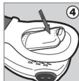
4. プラス・マイナスを間違えないよう新しい電池を入れ、確実に電池カバーを取り付けてください。絶対に電池カバー未装着での使用はしないでください。
