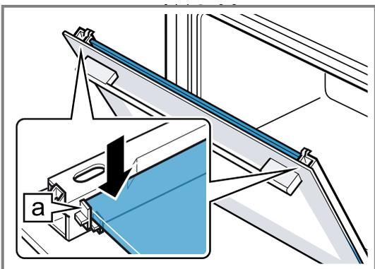
5. Die Gerätetür öffnen und Türdichtung einhängen.
