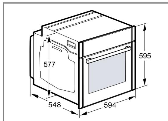
**28.3 Einbau unter einer Arbeitsplatte**
