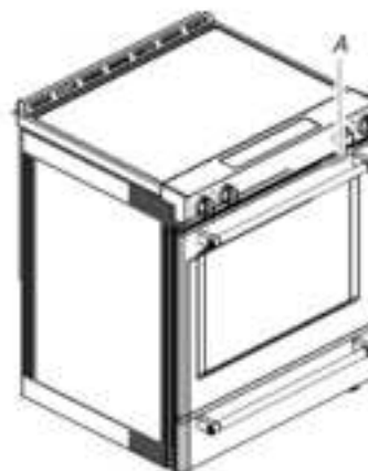
A. Plaque signalétique (située derrière la porte du four, dans le coin supérieur droit du châssis)
