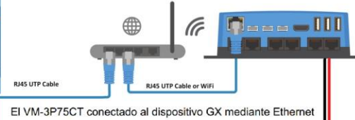
EI VM-3P75CT conectado al dispositivo GX mediante Ethernet
