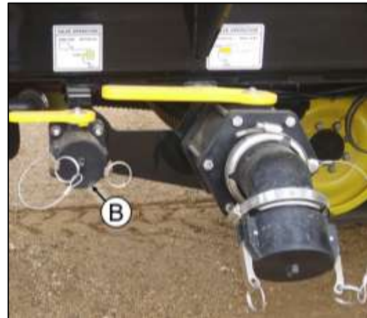
B. Rinse Tank Fill Line
