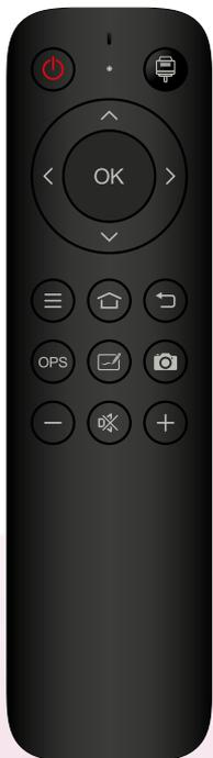
**Power (apagado / encendido):** Pulsación rápida - reposo / Pulsación superior a 1 segundo, muestra un mensaje previo de confirmación, si no cancelamos se apaga completamente al cabo de 10 seg. En caso de estar el OPS encendido, se iniciará el proceso de apagado del OPS antes.
