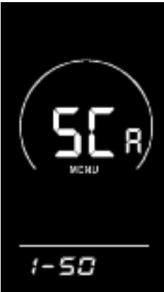
Fig. 8 Écran de réglage de la valeur du rapport de suralimentation
