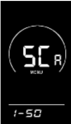
Abb. 8 Einstellungsbildschirm für den Wert des Boost-Verhältnisses
