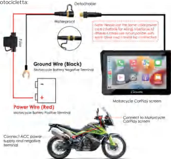
Il filo di alimentazione rosso dello schermo Carpuride è collegato al terminale positivo della batteria tramite un fusibile, mentre il filo di terra nero è collegato al terminale negativo.
