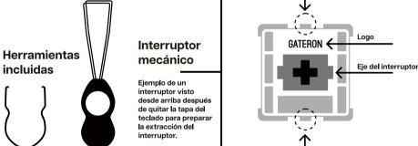
La herramienta de extracción de interruptores se alinea verticalmente con el interruptor para soltar el plástico que asegura el interruptor a la placa.
