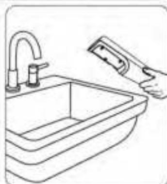
Tenez l'appareil sans la plaque de buses dans un lavabo, mettez-le en marche et maintenez les deux boutons de déclenchement enfoncés simultanément pendant plusieurs secondes. Ensuite, éteignez-le à nouveau.
