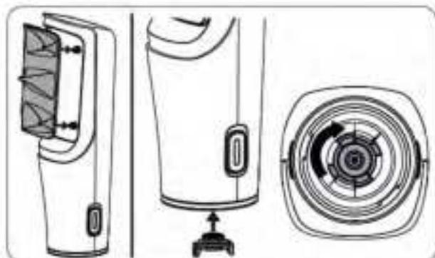
Laissez sécher complètement toutes les pièces de l'IONIQ ONE avant de le réassembler. Remettez en place l'adaptateur de cartouche et la plaque de buses. Poussez chaque buse individuellement vers le bas pour que la plaque de buses soit complètement enclenchée et affleure complètement sur l'appareil.
