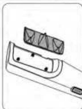
Retirez la plaque de buses et nettoyez-la soigneusement sous l'eau courante avec du savon doux en appuyant/frottant.
