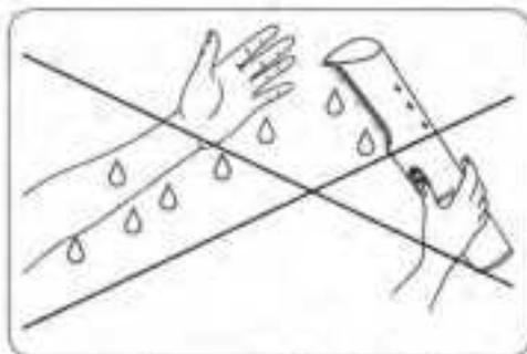
La peau, la plaque de buses, la partie derrière la plaque de buses et la cartouche doivent être séchées avant l'application. Si la peau est mouillée ou si l'appareil est contaminé, l'application peut être irrégulière (« taches blanches »).
