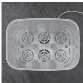
FIGURA B. Colocación de tubos de depósito de boca estrecha
