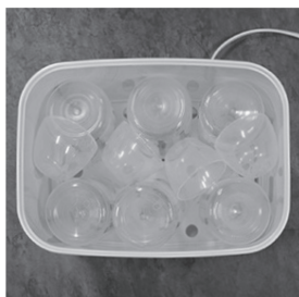
图 F. 宽口径奶瓶防护盖的放置 (底部2个, 上面4个)
