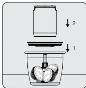
Поместив распорную крышку (3) (силиконовой прокладкой вниз) на стеклянную чашу (1), поместите блок двигателя (4) на узел.
