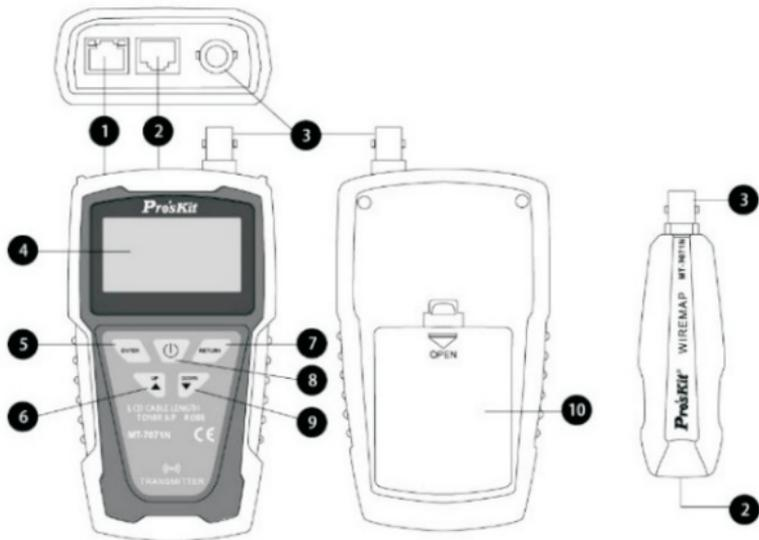
发射器及测试远程产品示意图
