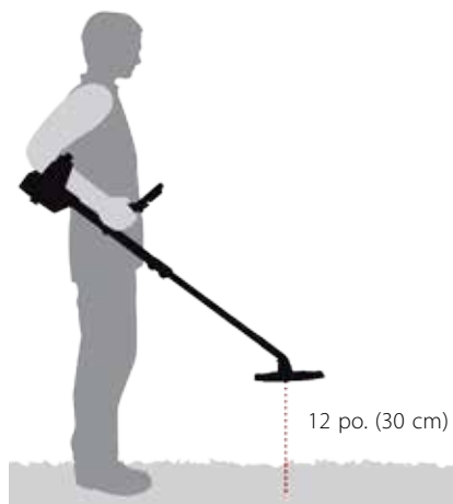
Figure 17 – Position de détecteur correcteur pour Elim. Interférences
