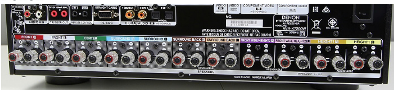
Der AVR-X7200WA wartet mit 9 Endstufen auf
