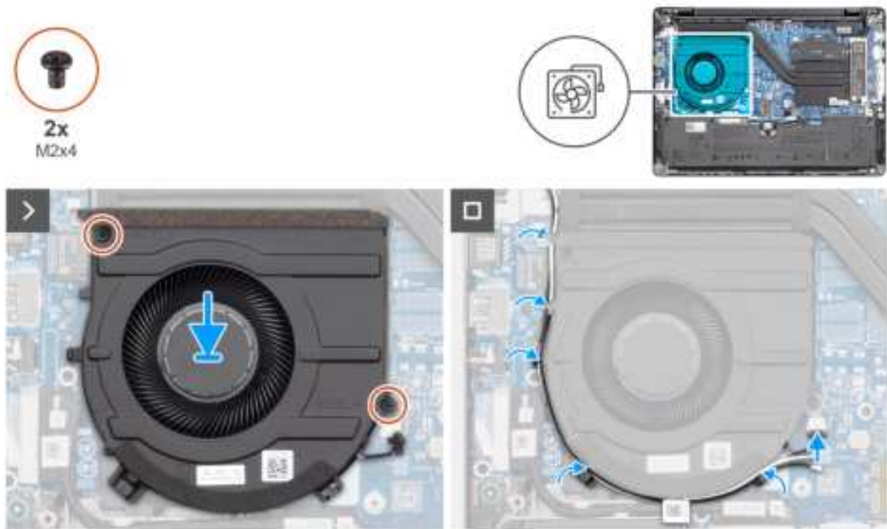
Figure 30. Installing the fan
