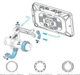
For 32mm handlebars, use a PVC gasket to prevent scratches. 根据车把直径选择合适尺寸的变径环,当车把直径为32MM时使用PVC垫片避免
