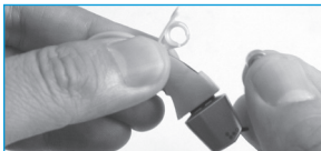
Figuur 6. Plaats van de batterij.
