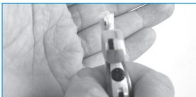
Figuur 5. Verwijder de oude batterij.
