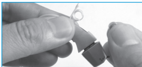
Figura 6. Inserimento della batteria.
