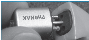
Abbildung 2 Empfänger an iConnect anschließen.
