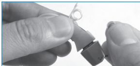
Abbildung 6 Neue Batterie einlegen.
