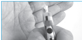
Figura 4. Apertura del vano batteria. Figura 5. Rimozione della batteria esaurita.
