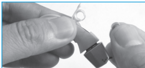
Figura 6. Introduzca la batería.
