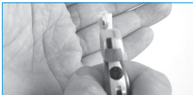
Figure 5. Retrait de la pile usagée.
