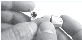
Figuur 4. Open het batterijcompartiment
