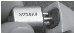
Figura 2. Conecte el receptor al adaptador iConnect.
