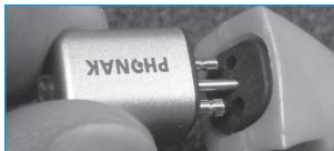
Figure 2. Branchement du récepteur à l'iConnect.
