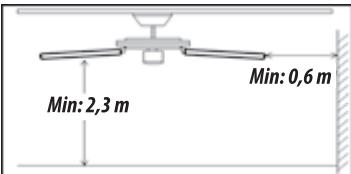
Wspornik montażowy podstawy wentylatora może wytrzymać obciążenie wynoszące maksymalnie 36 kg.
