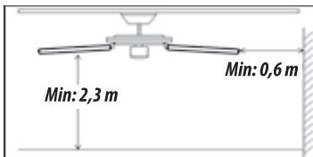
La staffa di montaggio della base della ventola può sostenere un carico di 36 kg.
