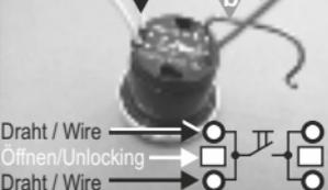
a) Verdrahtung / Wiring
