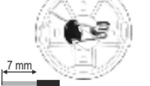
Drähte durch Dichtung führen
