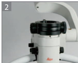
2 Установите светодетектор. Для наблюдения 50/50 % или 70/30 %.
