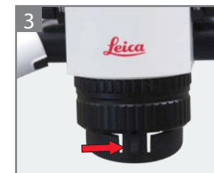
3 Наденьте защитное стекло на объектив. Выступ обра- щён вперёд (объективы точ- ной фокусировки) или по- вёрнут на 90° влево/вправо (фиксированные объективы).
