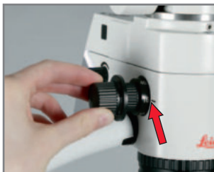
Регулятор увеличения с двух сторон, кратность: 6,4, 10, 16, 25, 40x
