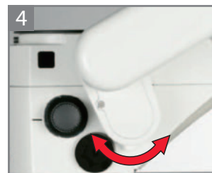
Установите желаемое положение. Можно установить четыре положения.
