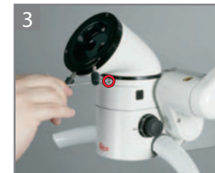
3 Затяните зажимной винт.
