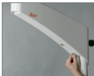
Снимите крышку горизонтального рычага.
