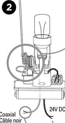
Si vous souhaitez améliorer la portée de vos télécommandes, vous pouvez brancher l'antenne située dans le feu clignotant avec un câble coaxial type RG58 (non fourni). Dans ce cas, vous devez déconnecter l'antenne d'origine. Branchez le cuivre central du câble coaxial sur la borne «ANT» et la tresse sur la borne «GND», côté antenne et côté carte électronique.
