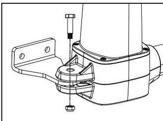
**2** Assemblez le deuxième support avec l'autre côté de l'automatisme puis vissez le support sur le portail fermé.
