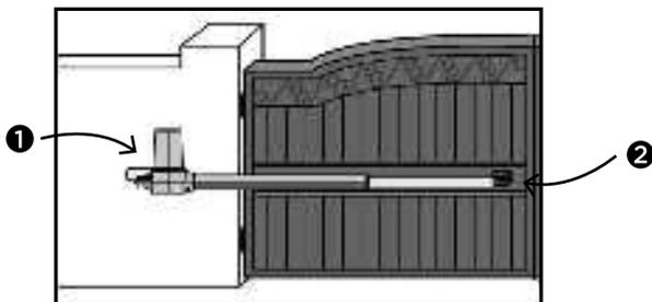
**1** Fixez le premier support sur le pilier. Positionnez l'automatisme dans le support, puis placez la vis et l'écrou.
