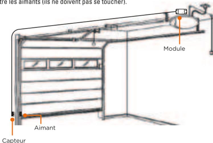
Le module indique si le portail / la porte est fermé(e) ou non fermé(e) grâce à l'aimant et au capteur.
