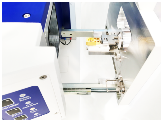
冷冻样品夹在室温下通过蔡司的标准样品交换室转移到冷冻平台上。
