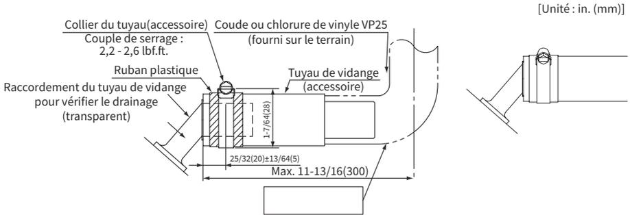
4. La tuyauterie de condensat doit être effectuée avec un pas descendant de 1/25 à 1/100.
