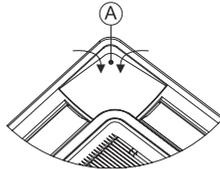
2. Tirez vers le bas le crochet en forme de U (à 2 positions) situé sur le côté de l'unité intérieure.
