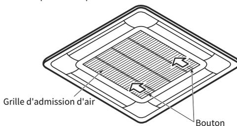
2. Maintenez la face inférieure de la calandre d'entrée d'air en la gardant inclinée. Retirez les crochets du filtre à air de la grille d'admission d'air et retirez le filtre à air.
