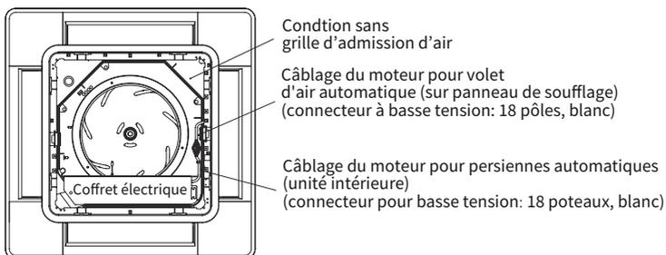
2. Après avoir connecté la connexion filaire du panneau d'air, fixez la grille d'entrée d'air. Réalisez les opérations de fixation en suivant la procédure de retrait en sens inverse.
