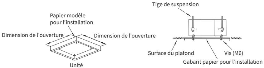
Serrez les écrous des supports de suspension après avoir effectué les ajustements. Appliquez de la COLLE FREIN sur les boulons et écrous pour empêcher qu'ils ne se desserrent. Si cela n'est pas fait, des bruits ou des vibrations pourraient se produire et l'unité intérieure pourrait se desserrer.
