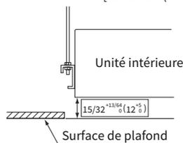
Sinon, réglez la distance en utilisant l'échelle de contrôle en maintenant l'unité intérieure à niveau.
