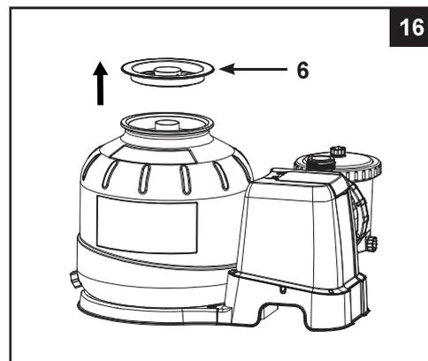
3. Remplissez uniformément la cuve de sable, puis versez un peu d'eau pour amortir le reste de sable qu'il reste à verser. Cela protégera le tube collecteur des chocs (**voir dessin 17**). Remettez en place le couvercle de protection de la cuve (6) et continuez le remplissage.
