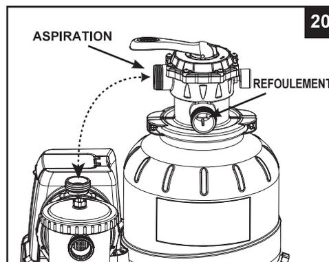
2. Placer un joint torique en forme de L (**11**) sur le raccord d'entrée de la vanne 6 voies et un joint torique en forme de L (**18**) sur la sortie du moteur de la pompe. Raccordez ces deux ports avec le tuyau de transfert (**13**) (**voir dessin 21**).
