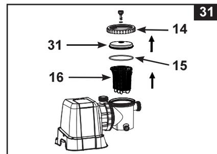
5. Videz et rincez abondamment le panier en utilisant un tuyau d'arrosage, utilisez si nécessaire une brosse plastique pour déloger les impuretés du pré-filtre. Ne pas utiliser une brosse en métal.
