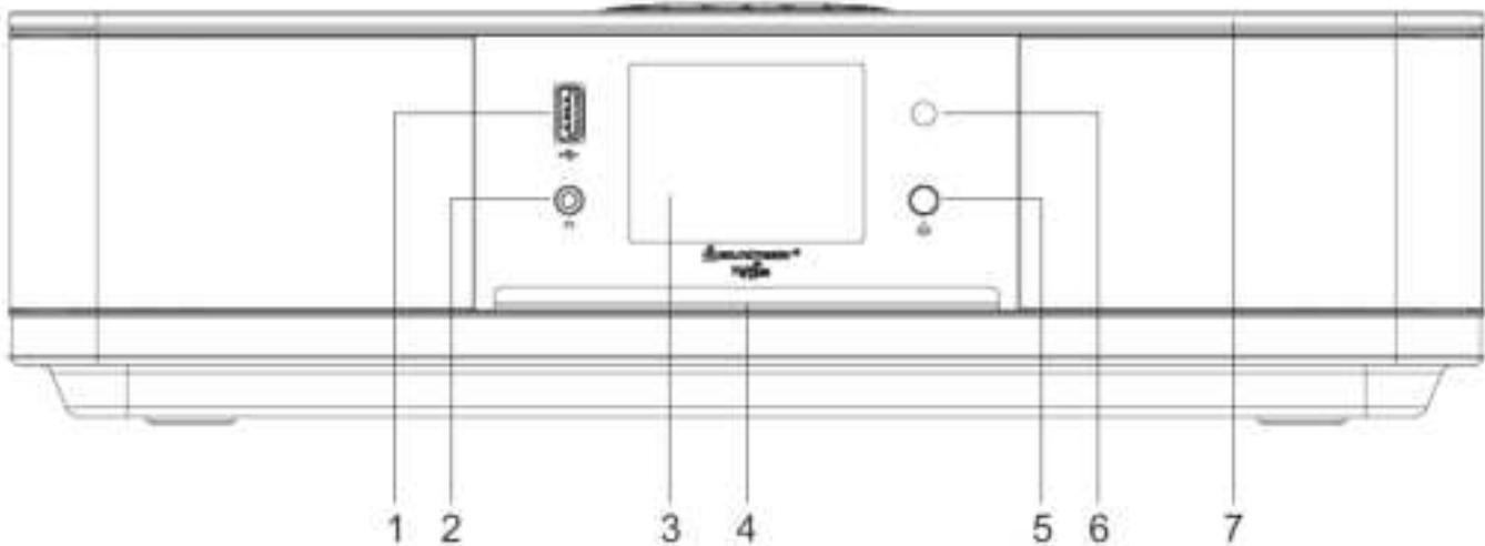
**1 USB Buchse****2 Kopfhörerbuchse****3 Display****4 CD Laufwerk****5****\* Auswurf der CD****6 Fernbedienungssensor****7 LED Ambientebeleuchtung****RÜCKANSICHT**
