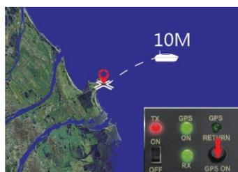
Drücken Sie die Taste GPS-ON am Sender länger als 5 Sekunden. Die grüne LED ändert sich von blinken auf dauerhaft leuchten, der Ursprungspunkt wird gespeichert.
