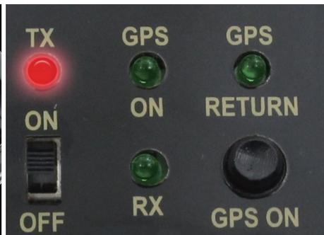
Schalten Sie die Fernsteuerung ein. Die TX LED leuchtet.
