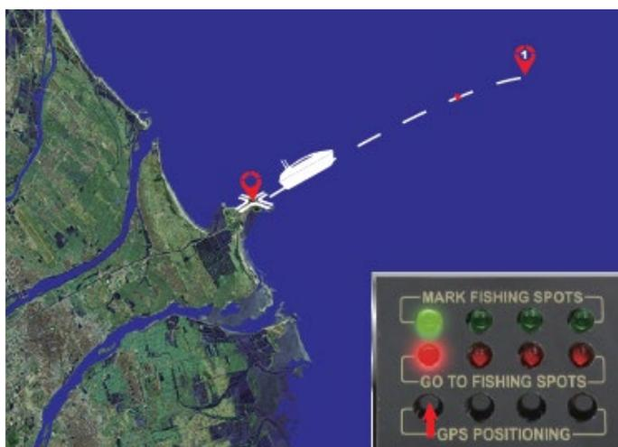
Wenn Sie möchten, dass das Boot zum markierten Angelplatz zurückkehrt, drücken Sie die GPS-POSITIONIERUNGSTASTE länger als 1 Sekunde. Das entsprechende rote Licht leuchtet dauerhaft. Das Boot fährt mit dem GPS-Autopiloten zum markierten Angelplatz.
