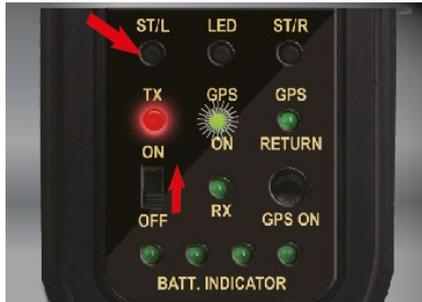
Stellen Sie zunächst sicher, dass der Sender ausgeschaltet ist. Batterie nicht mit Boot verbinden. Drücken Sie anschließend die ST / L-Taste und halten Sie sie gedrückt. Schalten Sie den Sender ein. Die TX-Anzeige leuchtet dauerhaft. Wenn die GPS ON-Anzeige blinkt, lassen Sie die ST / L-Taste los.
