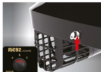
Befestigen Sie einen Metallring an der Angelschnur. Setzen Sie den Metallring auf die hintere Verriegelung. Drehen Sie den Knopf von C nach A. Der hintere Verriegelungsstift wird herausgezogen, um den Metallring zu verriegeln. HINWEIS: Diese Anordnung dient zum Lösen des Hakens. Wenn das Boot die Linie herausnimmt, wirkt die Zugkraft auf das hintere Schloss.
