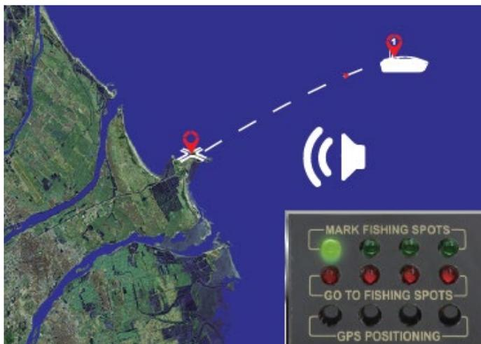
Wenn das Boot mit dem GPS-Autopiloten an der Stelle ankommt, erlischt das rote Licht und der Sender gibt einen Piepton aus, um anzuzeigen, dass das Boot an der markierten Angelstelle angekommen ist.
