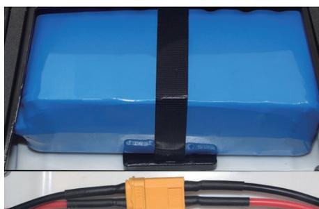
Befestigen Sie den Akku mit dem Klettband. Verbinden Sie den Akkustecker mit der Elektronik.
