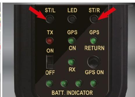
Wenn das Boot ohne Lenkbewegung nach rechts lenkt, drücken Sie die ST / L-Taste, um den Bootslauf gerade einzustellen. Wenn das Boot ohne Lenkeingabe nach links lenkt, drücken Sie die ST / R-Taste, um den Bootslauf gerade einzustellen.
