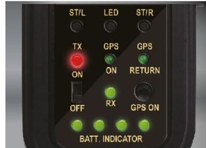
Verbinden Sie den Akku mit dem Boot. Schalten Sie den Netzschalter an der Rückseite des Bootsgriffs ein. Wenn die Anzeigen RX und BATT.INDICATOR aufleuchten, müssen Sie Sender und Empfänger binden.
