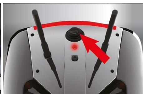
Schalten Sie das Boot über den Knopf hinten ein, die Kontrollleuchte leuchtet. Wenn Sie das Boot für eine kurze Zeit nicht benutzen, schalten Sie das Boot über den Power-Knopf aus. Wenn Sie das Boot für eine längere Zeit nicht benutzen, trennen Sie den Akku vom Empfänger.
