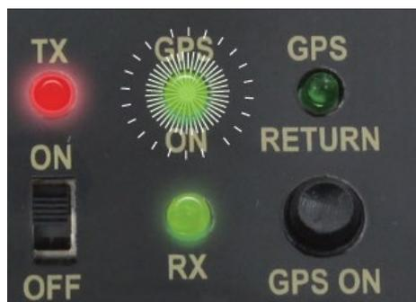
Warten Sie, bis das grüne Licht GPS-ON zu blinken beginnt. (Anmerkungen: Je nach den Umständen dauert es ca. 3-5 Minuten.) Dies zeigt an, dass der GPS-Modus am Empfänger funktioniert.
