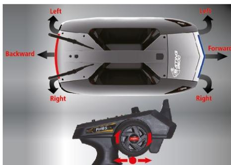
Ziehen Sie den Gashebel zurück, das Boot bewegt sich vorwärts, drücken Sie den Gashebel vorwärts, das Boot bewegt sich rückwärts; Drehen Sie das Rad gegen den Uhrzeigersinn, das Boot dreht sich nach links, drehen Sie das Rad im Uhrzeigersinn, das Boot dreht sich nach rechts.
