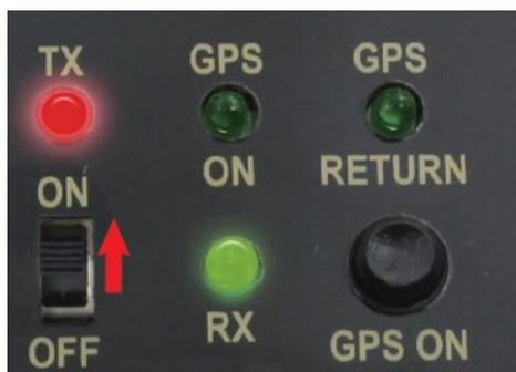
Schalten Sie zuerst den Sender ein. Schließen Sie dann den Akku am Boot an. Das rote TX-Licht und das grüne RX-Licht leuchten beide auf. (Zeigen an, dass der Sender und das Boot funktionieren.)
