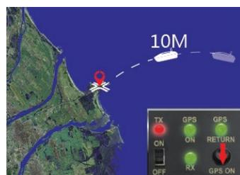
Nachdem das Boot zur gewünschten Stelle gefahren ist, drücken Sie die Taste GPS-ON für 1 Sekunde. Das grüne Licht für GPS-RETURN leuchtet dauerhaft. Das Boot kehrt automatisch zum Ursprungspunkt zurück. Wenn das Boot zurückgekehrt ist, hören Sie einen Signalton. Die GPS-RETURN-Anzeige erlischt.
