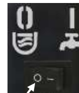
Schalter in Wassertankposition „0“
