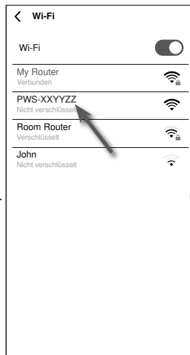
(c) Wählen Sie den Namen des WLAN-Netzwerks der Basisstation (der Name beginnt immer mit PWS-), um Ihr Smartphone mit der Basisstation zu verbinden. Gehen Sie dann zurück zur WSLink-App.
