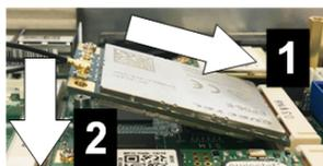
10) Fissare nuovamente la scheda con la vite. Controllare il saldo posizionamento del cavo di allacciamento dell'antenna.
