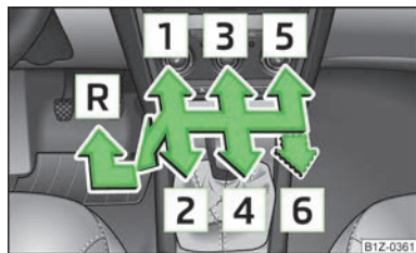
pav. 98 Pavarų perjungimo schema: 5 arba 6 pavarų mechaninė pavarų dėžė
