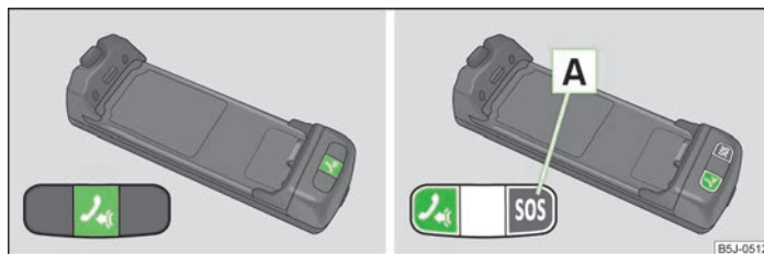
pav. 107 Principinis pavaizdavimas: vieno mygtuko adapteris / dviejų mygtukų adapteris
