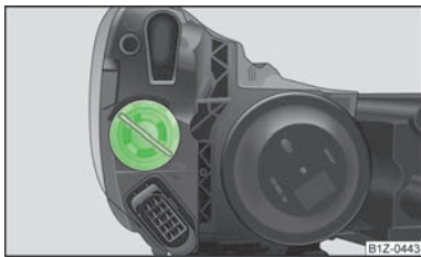
pav. 161 Priekinių posūkių šviesų kaitinamosios lemputės išmontavimas
