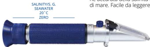
La scala appositamente progettata legge la salinità da 20-40ppt e il peso specifico da 1.015-1.030
