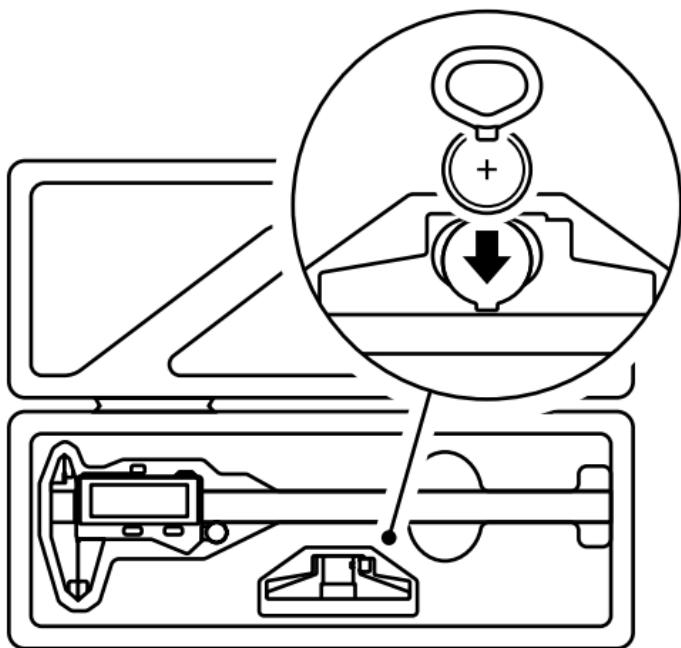
**Úložný prostor pod hloubkovým dorazem slouží k uložení nástroje a náhradní baterie.**
