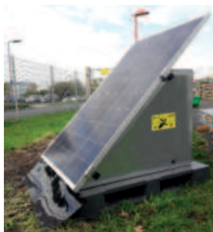
Figur 3.1: PVC Streifen schützt gegen Beschattung des Solarmodules
