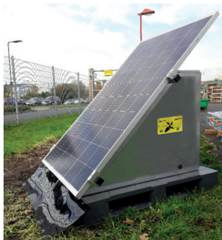
Figur 3.1: Plastfilmen gör att solpanelen inte skuggas av uppväxande vegetation.
