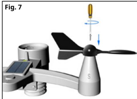
4) Insérez le bouchon en caoutchouc étanche dans l'orifice de la girouette et faites-le tourner pour vérifier qu'il pivote librement.
