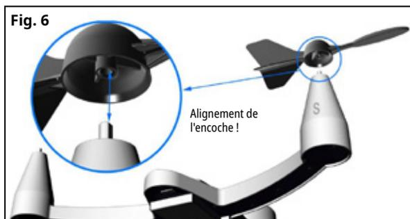
3) Serrez la vis de blocage à l'aide du tournevis fourni jusqu'à ce que la girouette ne puisse plus être retirée de l'axe.
