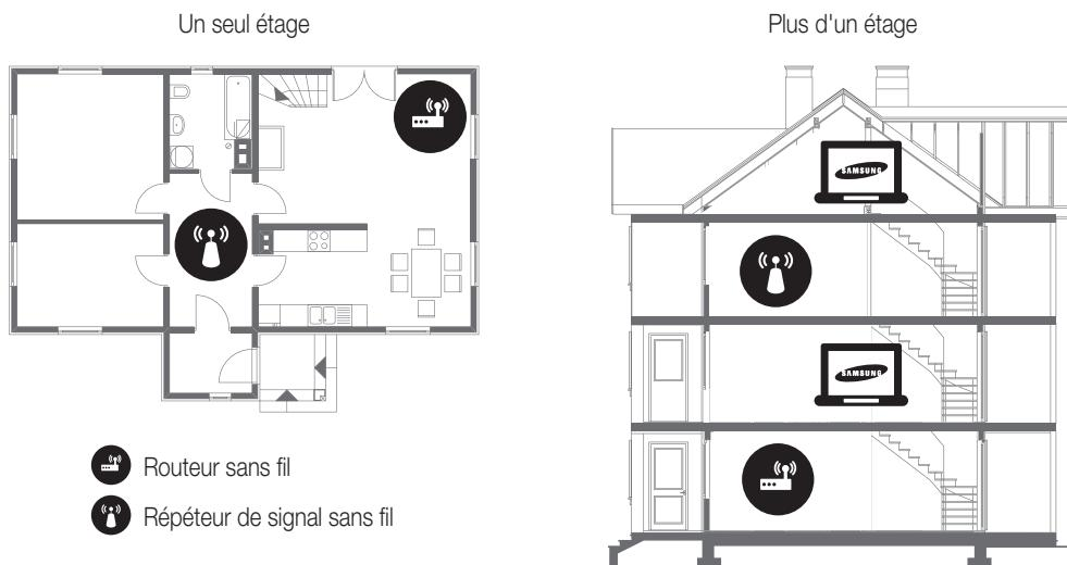
**Ne disposez pas le routeur sur le plancher, et évitez qu'il soit en contact avec un mur ou un objet métallique.**
