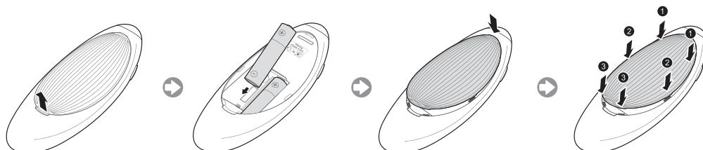
1. Tirez doucement sur la languette du couvercle du logement des piles, puis retirez le couvercle complètement lorsqu'il se détache.
