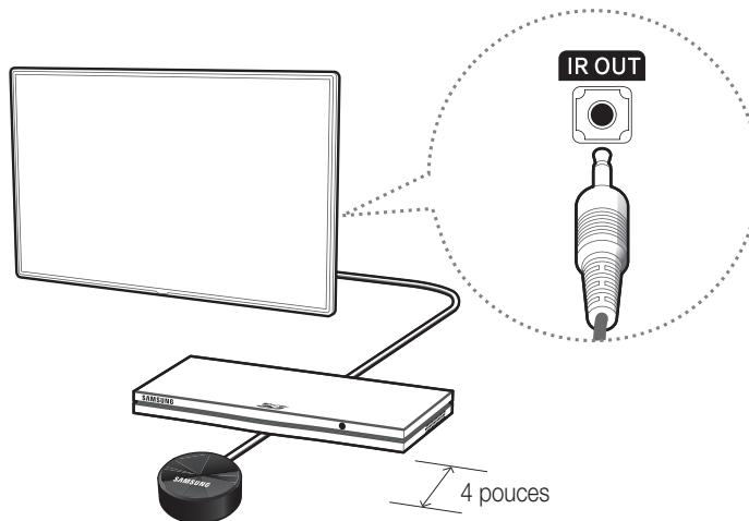
Pour lancer le processus de configuration de la télécommande universelle, connectez le câble de rallonge IR (inclus) à la prise de sortie IR sur le téléviseur, comme l'indique le diagramme, et ensuite positionnez l'extrémité transmetteur du câble, en respectant une distance de 4 pouces (10 cm), vers le capteur de télécommande de l'appareil récepteur.
