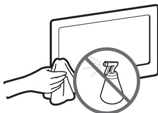
Ne vaporisez pas de l'eau ou de liquide nettoyant directement sur le téléviseur. Tout liquide qui s'infiltrerait dans l'appareil risque de provoquer une défaillance, un incendie ou une décharge électrique.
