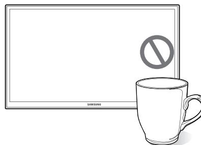
Évitez d'obstruer le capteur par un objet. Cela diminuerait la luminosité de l'image.
